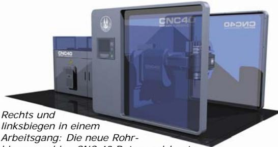
*Rechts und linksbiegen in einem Arbeitsschritt: Die neue Rohrbiegemaschine CNC 40 Rotary zeichnet sich durch geringere Rüstzeiten, niedrigere Anschaffungskosten und ein intuitives Steuerungskonzept aus.*
