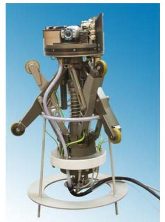
Dieser Manipulator des Typs J900s ist mit einem Farbeindringmodul ausgerüstet (oben) und bewegt sich sicher in Rohren mit Innendurchmessern von 750 bis 1000 mm.
