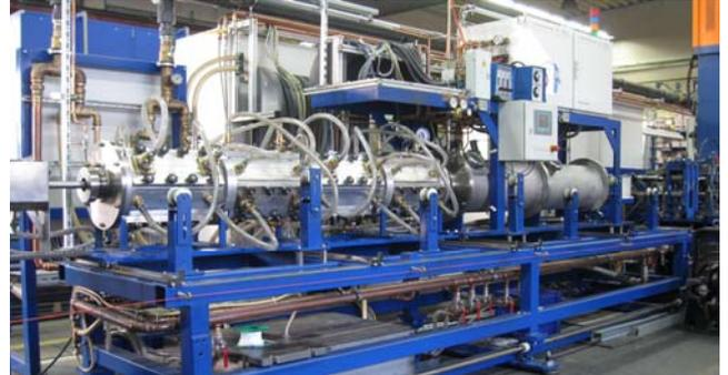
Wuppermann hat das Rekristallisationsglühen in eine Edelstahlrohrstraße In-Linie integriert.
